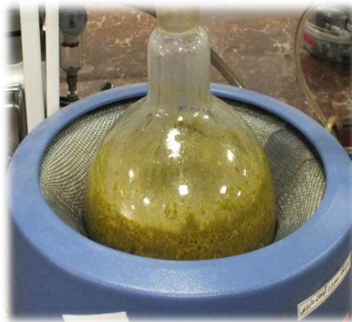
شکل شماره ۲ و ۳ : مرحله اسانس گیری توسط دستگاه کلونجر
