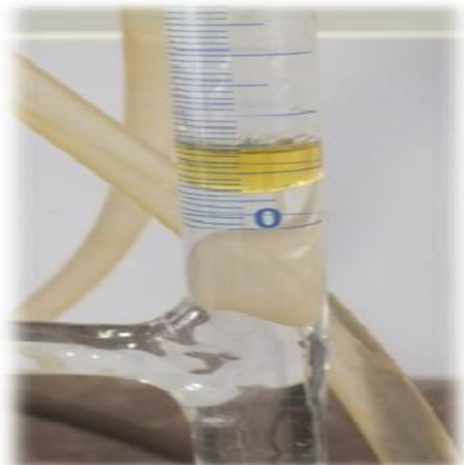
شکل شماره ۲ و ۳ : مرحله اسانس گیری توسط دستگاه کلونجر
